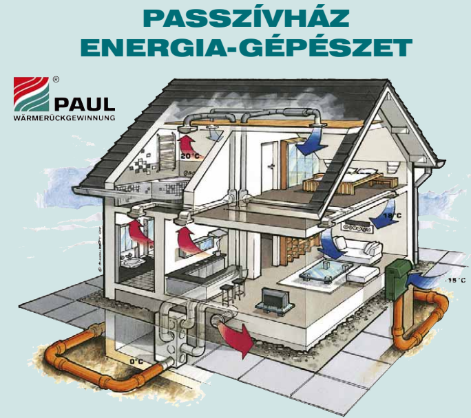
Hőszivattyúval és napenergia-hasznosítással kiegészített hővisszanyerős szellőzés
